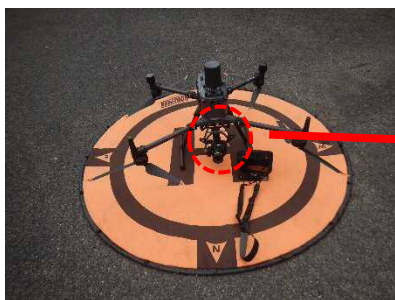
UAVへの赤外線カメラ取付状況
