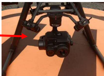
UAVへの赤外線カメラ取付状況
