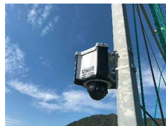
SIM 内蔵カメラの設置 （ソーラー、バッテリー駆動可）
