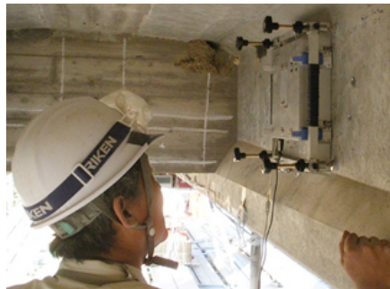
ライセンススキャナタイプ全視野ひずみ計測装置と計測状況
