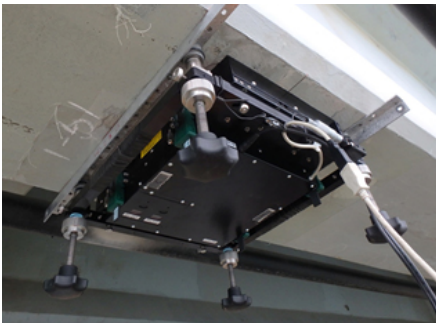
ライセンススキャナタイプ全視野ひずみ計測装置と計測状況
