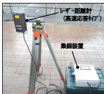
変位モニタリング装置
