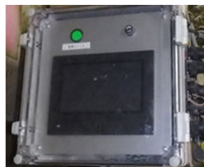
リアルタイム変位計測装置(例)
