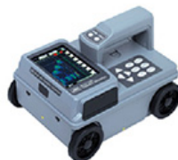
写真2: RCレーダー(電磁波レーダー法) 電磁波レーダー法のかぶり測定については、比誘電率による補正が必要となります。
