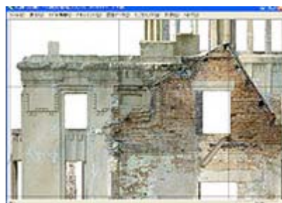
詳細確認したい壁面を、オルソ画像(正射投影図)での表示が可能
