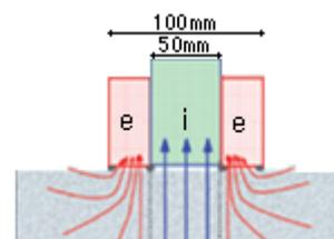
※測定部セル(i)の正確な測定のために、測定部セル(i)の外側に外周セル(e)を配置し周囲の影響を排除しています。
