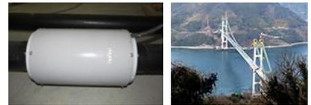
EMセンサー（左）と、EMセンサーを適用した橋梁事例（豊島大橋 広島県）
