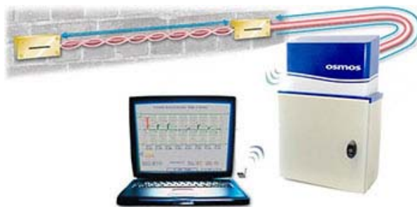
センサ～モニタリングステーション～PC 等の接続イメージ
