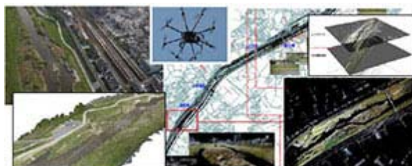
図2 河川整備の出来形を光学的計測手法を用いて3次元情報取得の例
