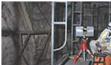
写真1 3Dレーザ計測状況
