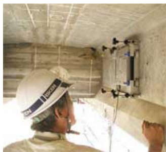
ラインセンサスキャナタイプ全視野ひずみ計測装置と計測状況
