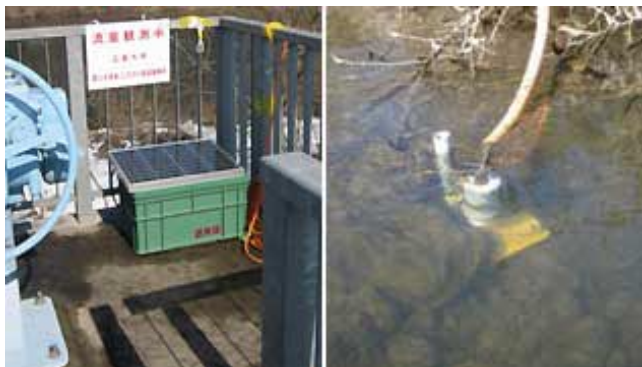
新開発の河川音響トモグラフィーシステム設置場所(左)と音響局設置の様子(右)事例
