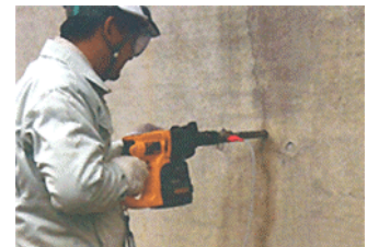
1.ドリルによる検査孔の削孔
