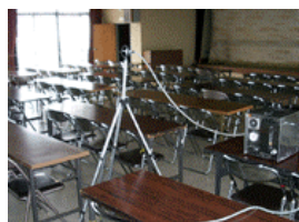
空気中の石綿粉じん濃度測定状況
