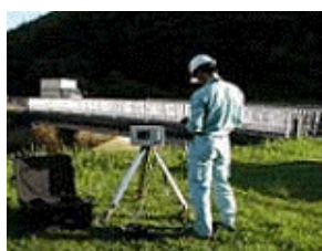
3Dレーザースキャナによる 形状寸法測定状況
