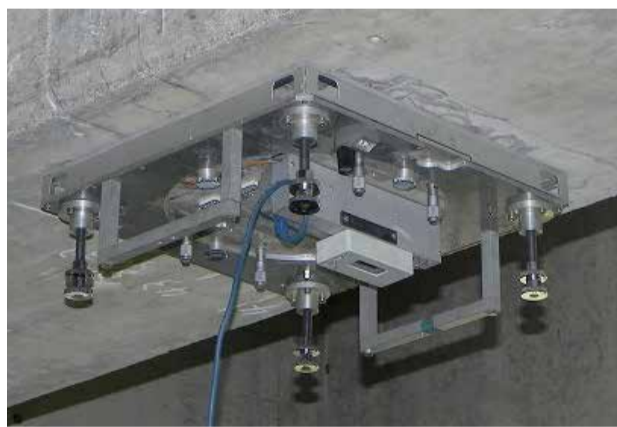
光学式全視野 計測装置での計測 (変形後画像)
